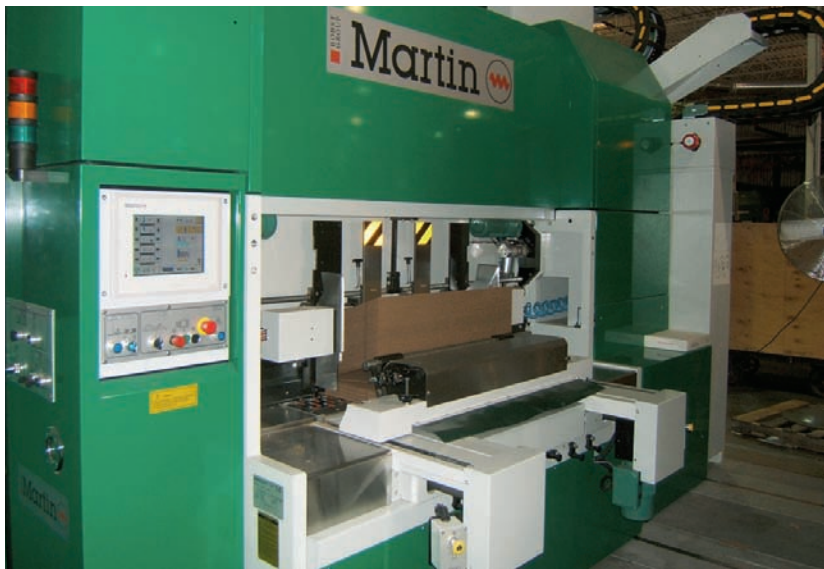
Tilsner's two-color Martin mini 618 flexo folder-gluer
